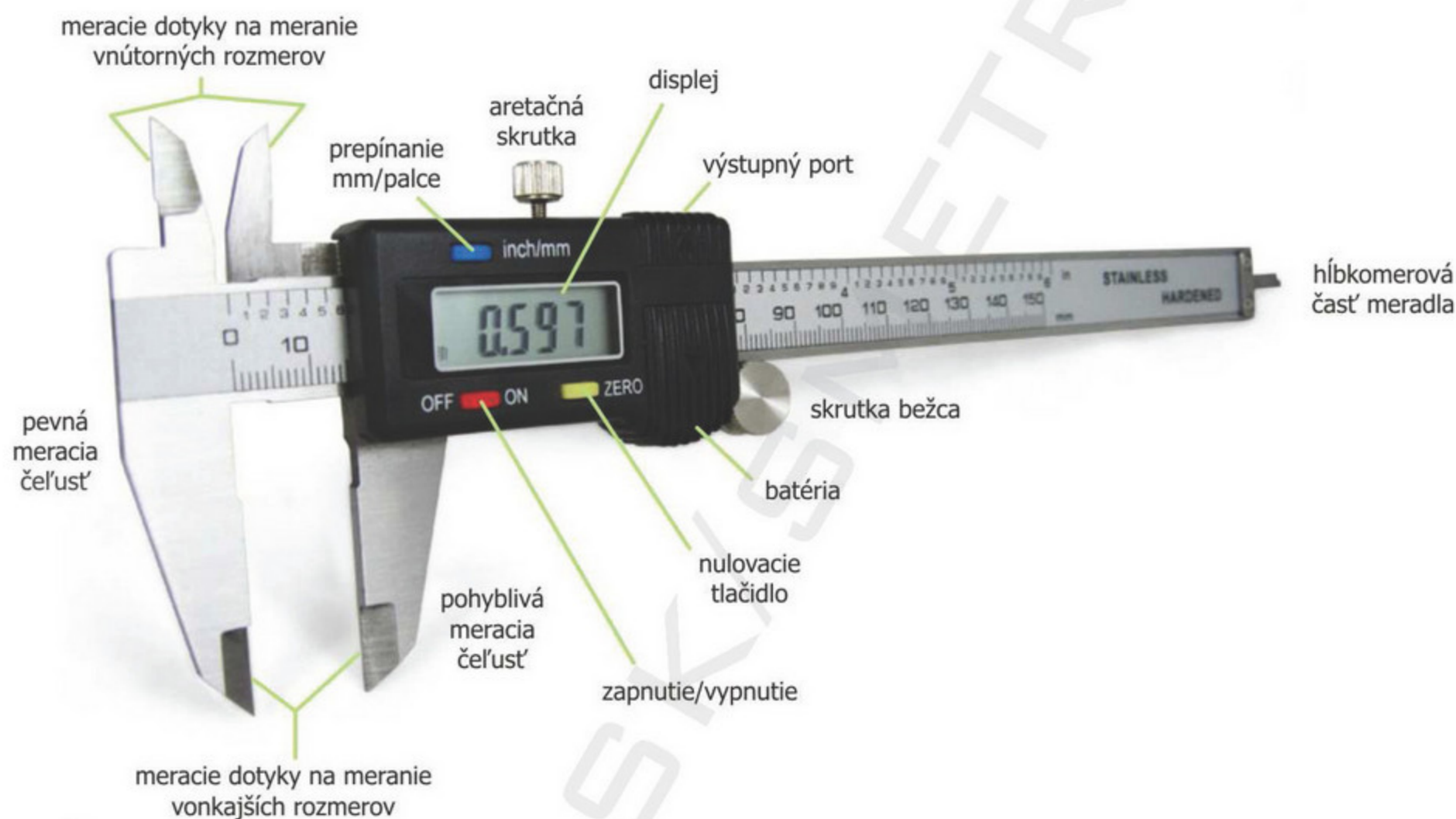
Obr.3.3 Popis základných častí digitálneho posuvného meradla
