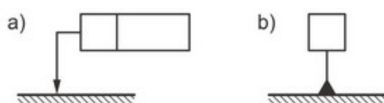
Obr.7.3 Ukážka tolerančného rámčeka na výkrese a) označenie tolerovaného prvku b) označenie základného prvku, základne
