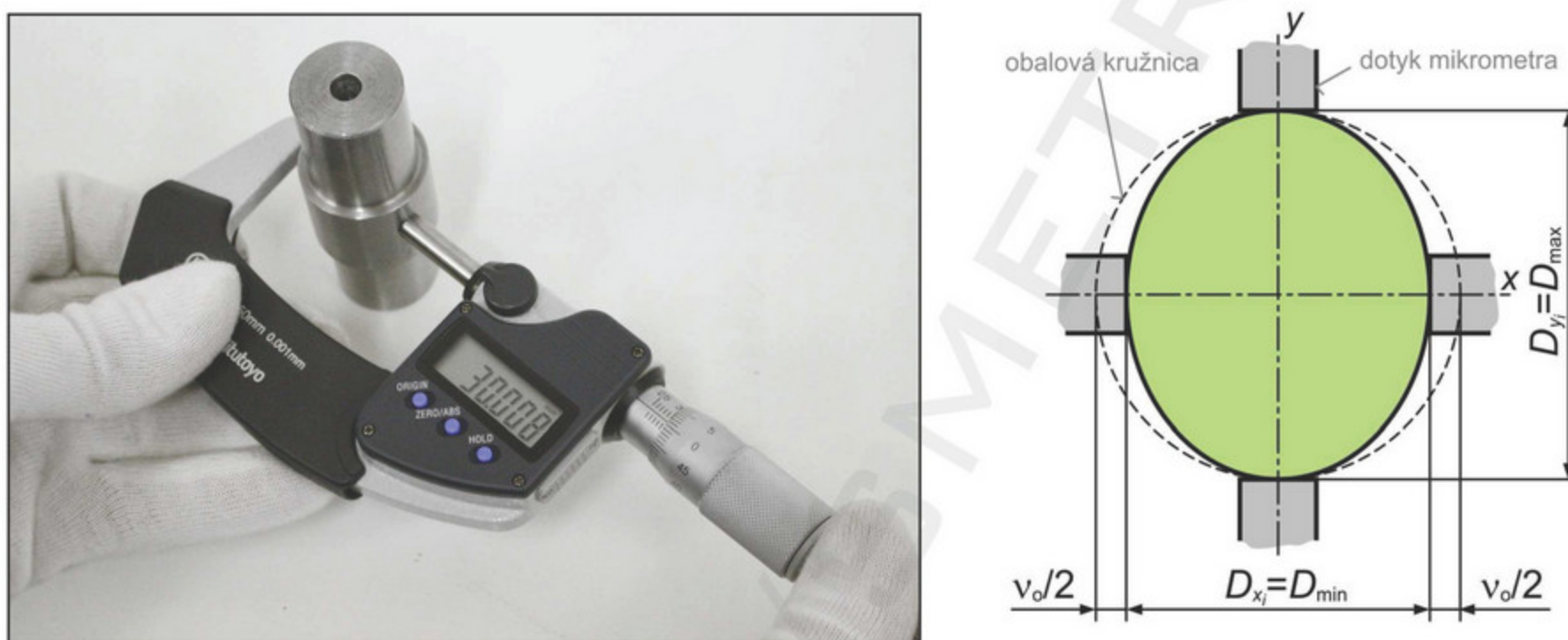
Obr.9.4 Meranie a schéma merania kruhovitosti dvojbodovou metódou
