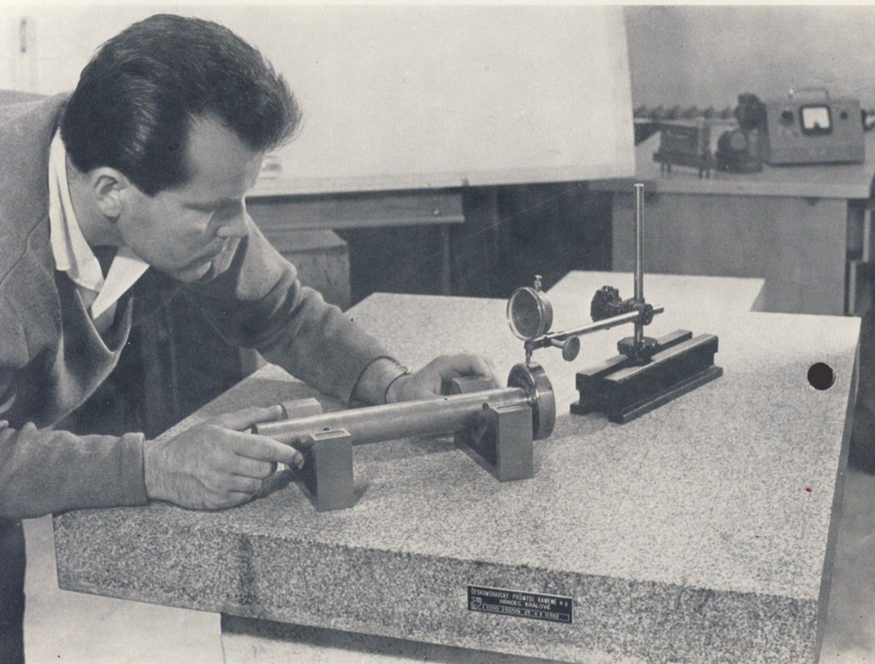
Pracovní záběr při použití kamenné desky na kontrolu valivého ložiska
