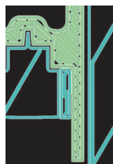
Obr. 3 3D tiskárna Dimension SST 768 firmy Stratasys, vygenerovaný řez s trajektorií nanášení materiálů a detail na trajektorii
