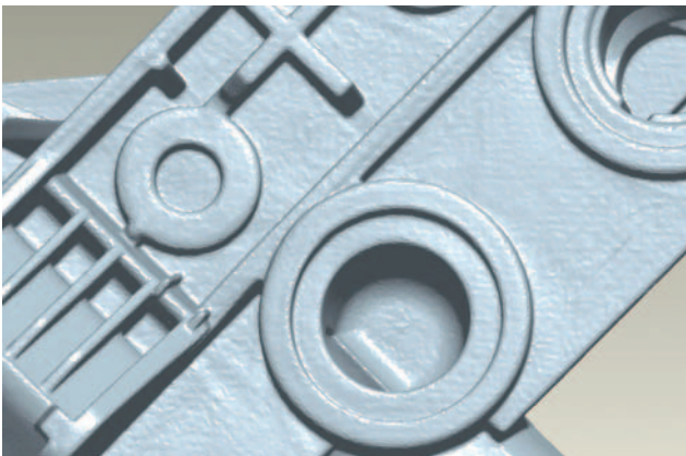
Obr. 7 Detailní pohledy na STL modely importované do programu Pro/Engineer. Vlevo je model z původního dílu a vpravo z kopie vytisknuté metodou FDM.
