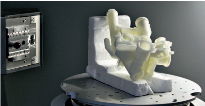
Obr. 6 Vytisknutý díl osazený v průmyslovém CT přístroji
