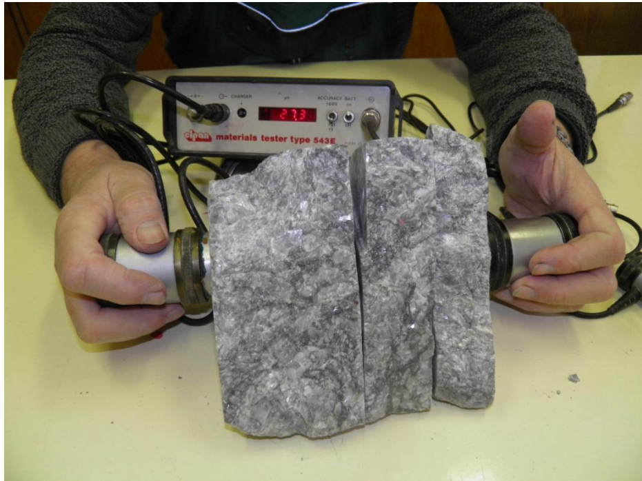
Obr. 1: Ultrazvukový prístroj Material tester – stanovenie porušenosti horninového prostredia
